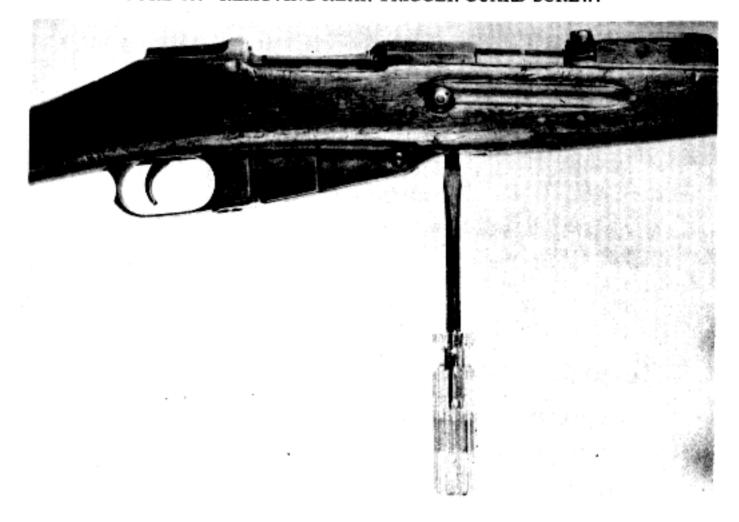
FIGURE 50. REMOVING THE FRONT TRIGGER GUARD SCREW.
