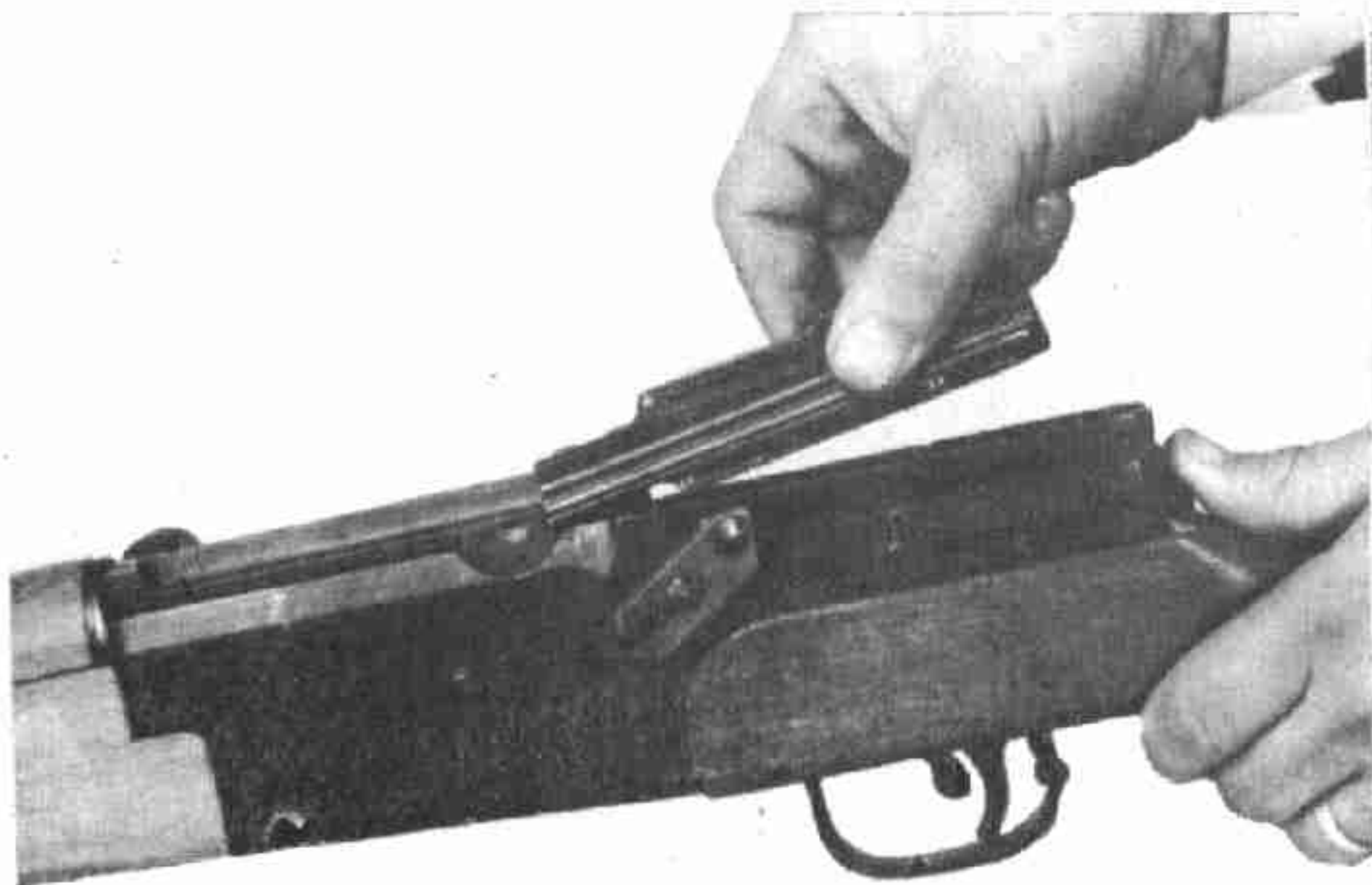
Fig. 5. - Démontage du couvre-culasse.
